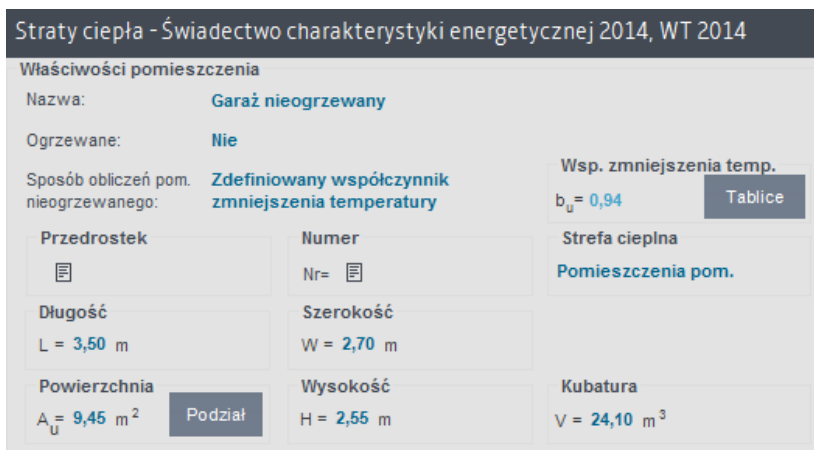
Okno właściwości pomieszczenia nieogrzewanego. Zdefiniowany współczynnik zmniejszenia temperatury.
