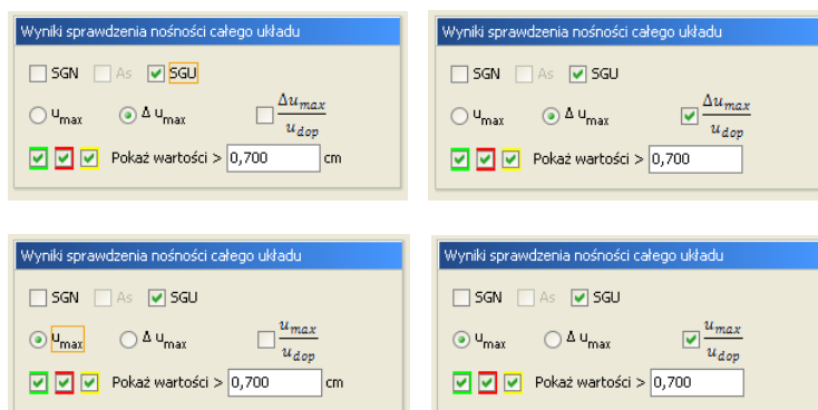
Rys. 14.22 Filtrowanie wyników dla prętów i stanu granicznego użytkownika
