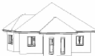
Model siatkowy z ukrytymi powierzchniami krawędziami
