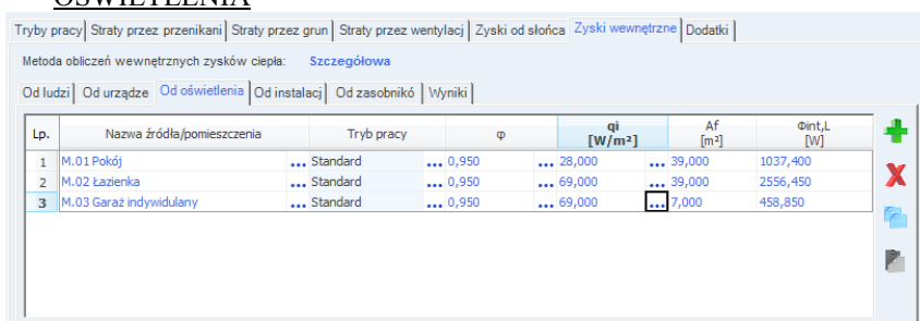
Rys 280. Zakładka wewnętrznych zysków ciepła metoda szczegółowa zyski od oświetlenia
