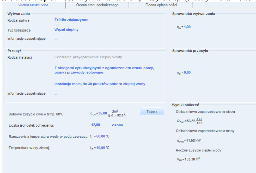
Rys 352. Zakładka oceny sprawności ciepłej wody użytkowej wg Rozporządzenia MI z 14.02.2008.
