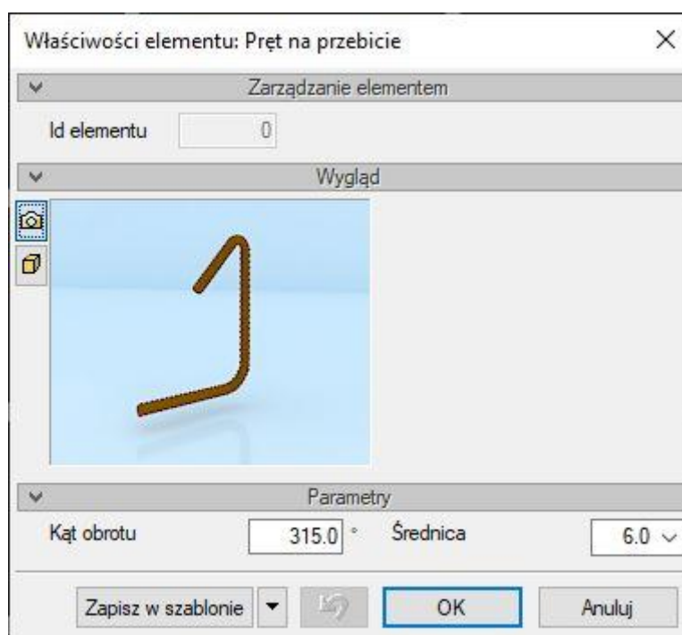
Rys. 28 Okno Właściwości pręta na przebicie
