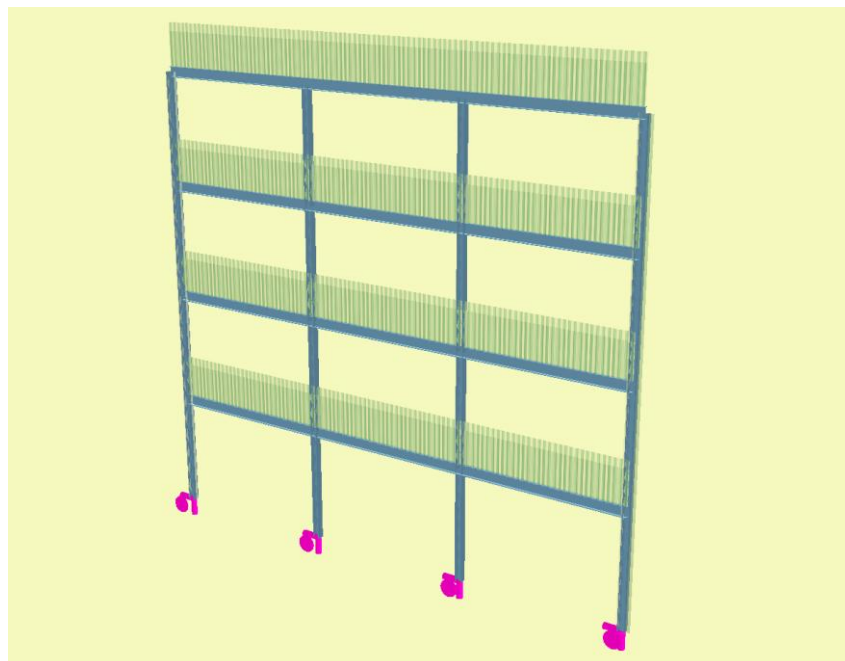
Rys. 13.3 Rama stalowa wielokondygnacyjna – wariant I
