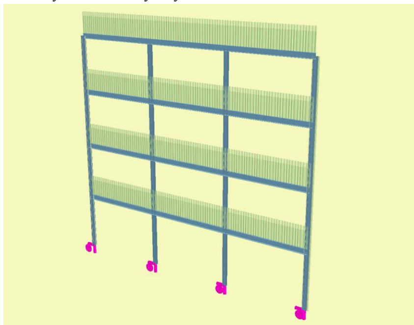
Rys. 13.3 Rama stalowa wielokondygnacyjna – wariant I
