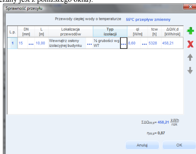
Rys 346. Okno certyfikatu obliczenie sprawności przesyłu
