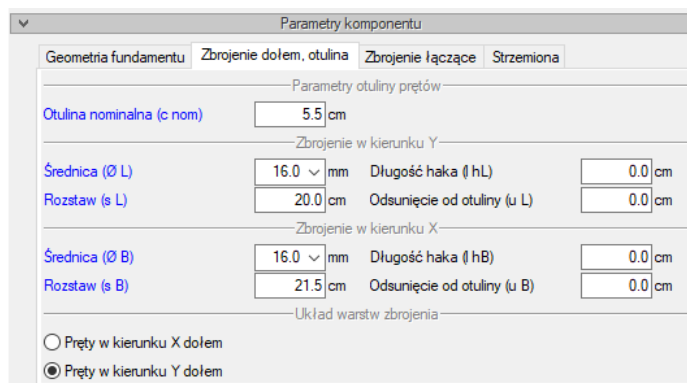
Rys. I.44 Parametry wyróżnione kolorem niebieskim uzyskały wartość automatycznie po eksporcie z programu ArCADia-RAMA
