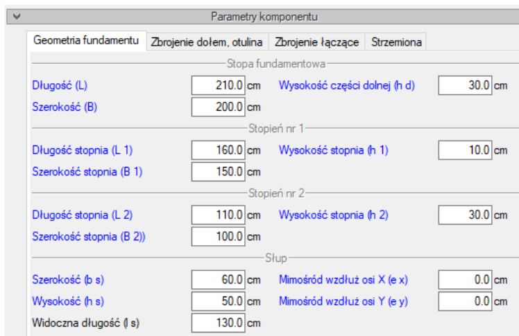
Rys. I.43 Parametry wyróżnione kolorem niebieskim uzyskały wartość automatycznie po eksporcie z programu ArCADia-RAMA
