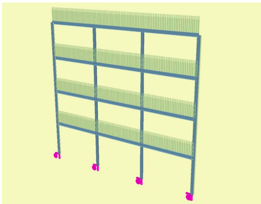
Rys. 13.3 Rama stalowa wielokondygnacyjna – wariant I
