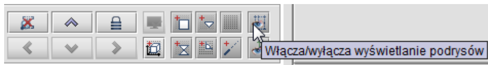
Rys. 2.17 Włączanie i wyłączanie podrysu w projekcie
