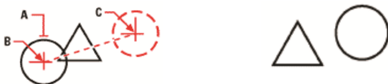
Rys. 242 Przykład przesunięcia: wybrany element (A), punkt bazowy (B) i punkt przemieszczenia (C)
