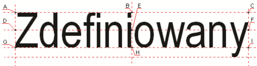
Rys. 211 Punkty wstawiania tekstu: A – Góra lewo; B – Góra symetria; C – Góra prawo; D – Centrum lewo; E – Centrum symetria; F – Centrum prawo; G – Dół lewo; H – Dół symetria; I – Dół prawo
