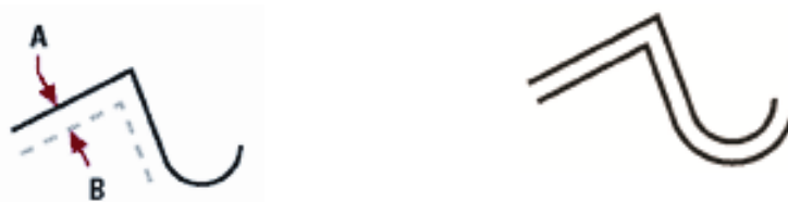
Rys. 241 Przykład opcji odsunięcia: wybrany element (A), zadana odległość, wskazany kierunek umieszczenia kopii (B)
