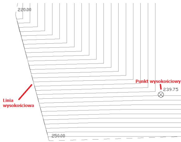
Rys. 156 Elementy terenu na rzucie
