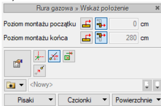
Rys. 38. Widok okna wstawiania rury gazowej pionowej z uruchomioną funkcją rysowania z pobieraniem wysokości z poziomu kondygnacji
