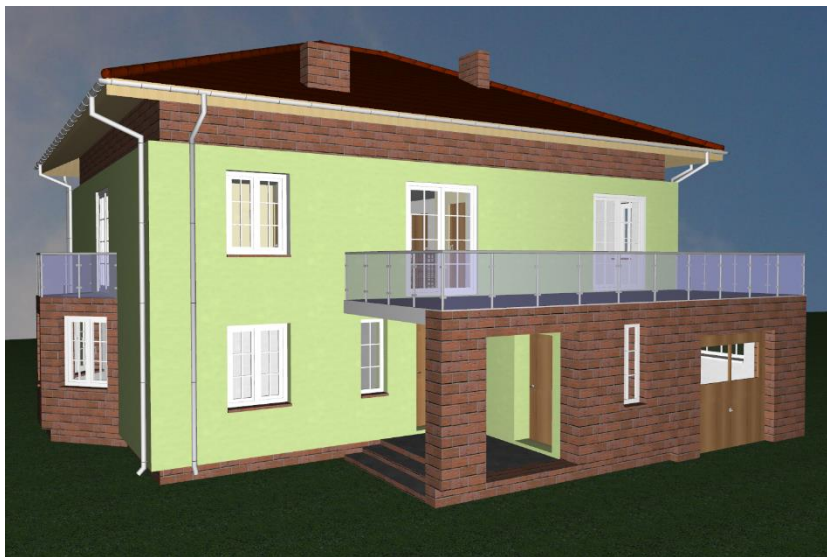
Rys. 283 Przykład wprowadzenie balustrady na tarasie
